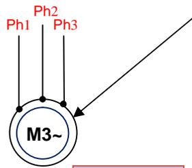
Le stator étant alimenté par un système de tension alternatif triphasé produit un champ tournant à la vitesse de synchronisme
