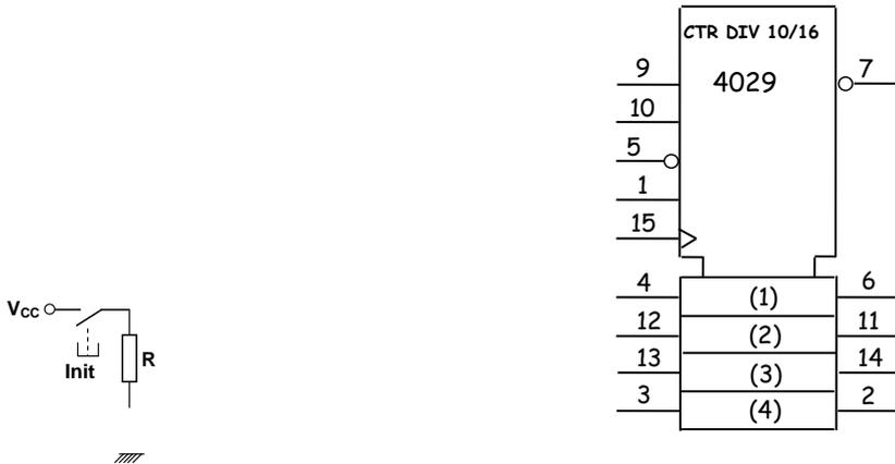
2°) Compléter le circuit suivant pour avoir un décompteur binaire de cycle 12-11-10-9-8-7-6-5-4-3-2-1-0 avec un bouton d'initialisation
