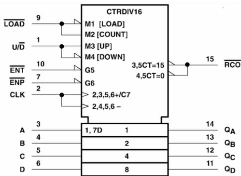
“C7” agit sur “7D” et permet de faire un chargement sur front d’horloge lorsque “M1” est active.
