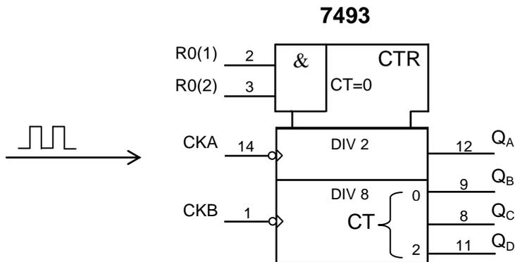
b - 2<sup>ème</sup> solution : Le signal d'horloge est appliqué à l'entrée CLKB:
