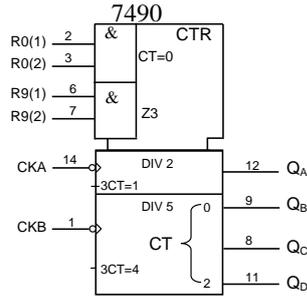
3°) Soit le circuit suivant réalisé avec le CI 7490 compléter les chronogrammes
