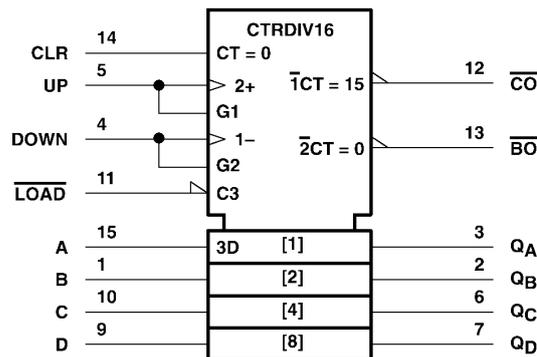
b- Réaliser un compteur qui compte de 2 à 200 avec les CI 74193 .Prévoir une entrée d'initialisation à 2 (cascade asynchrone)
